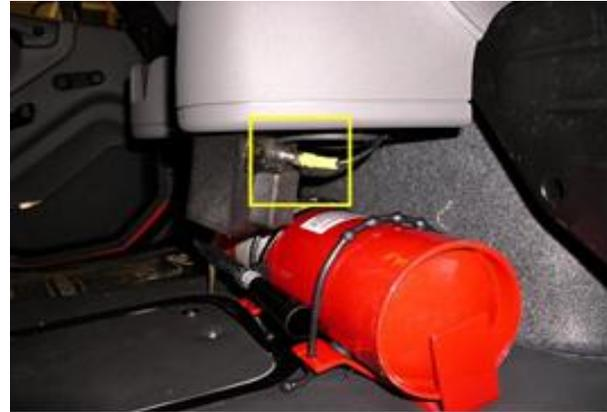
Opción 1: bajo el tablero, montaje del interruptor HTS    Guarniciones de micro-cables que se unen con interruptor trasero
