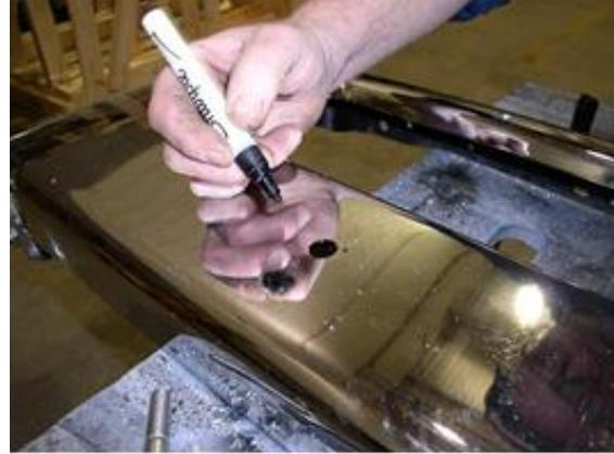
La utilización de una pluma de pintura negra cubre los bordes interiores de los 1/2" agujeros para proteger el parachoques del oxido.
