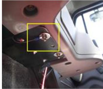
**Montaje de cable de tierra a la superficie metálica**
